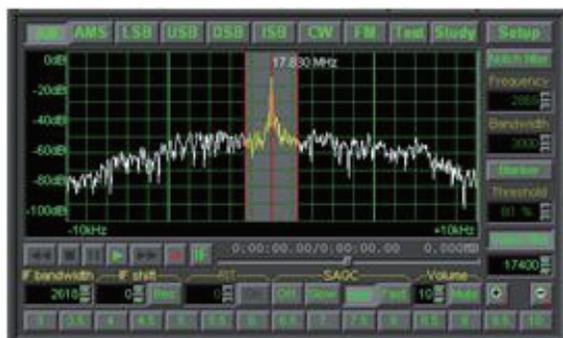
模块能够记录音频及20KHz宽的中频信号，可以用不同的中频滤波带宽、陷波滤波器、噪声抑制或解调。设置反复“再接收”同一信号，从而最大程度优化弱信号或受干扰的信号的接收效果。
