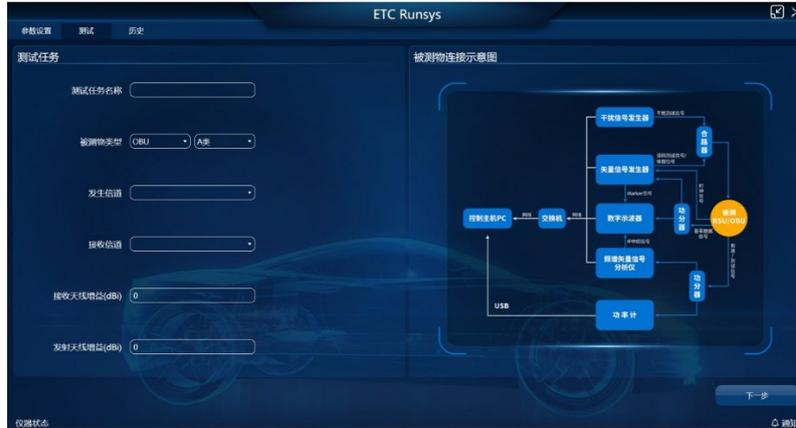
在测试任务界面根据被测物的类型新增测试任务，还可根据被测物连接示意图检查物理链路是否正确连接正确。
