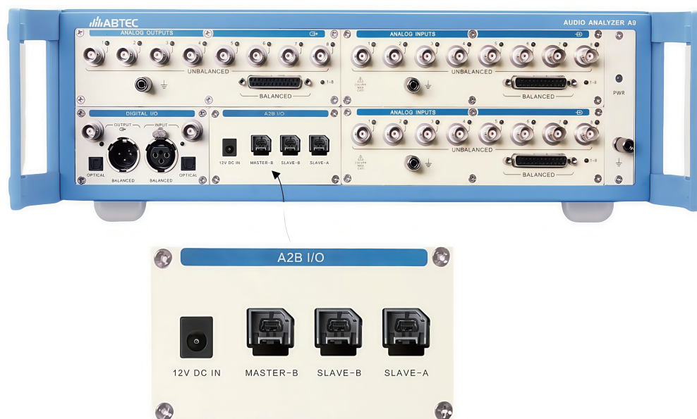
图2 A 2 B选件安装示意图
